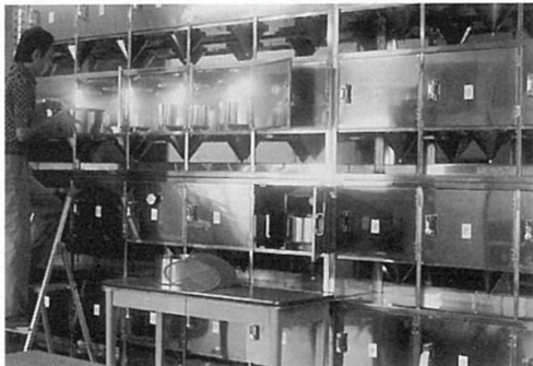
写真1. 横浜国立大学のツルグレン装置室。1つの棚が5×4の20個のツルグレン装置よりなる。限られたスペースに多くの装置を設置できるのが便利であるが、一度に大量の電力を消費するため、ヒューズが飛びやすい。
