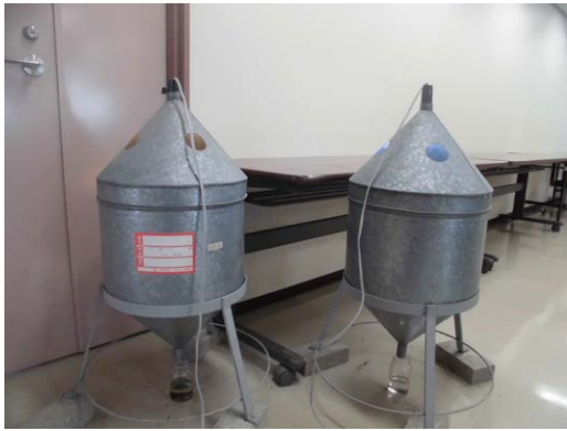
図1. 実験中のツルグレン装置. 左：白熱電球を装着した従来型装置. 右：LED電球を装着した装置.
